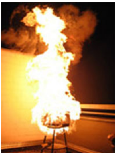
Bild 5: Verpuffung bei der Verwendung von ungeeigneten flüssigen Anzündern
